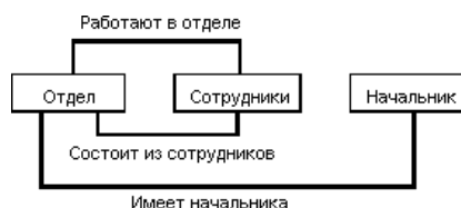
Рис. 6 Сетевая модель данных
