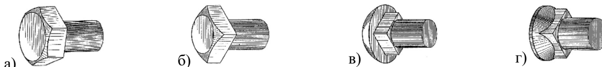
Рисунок 7 Формы головок болтов: а – шестигранная, б – квадратная, в - сферическая с квадратным подголовком, г – потайная с квадратным подголовком
