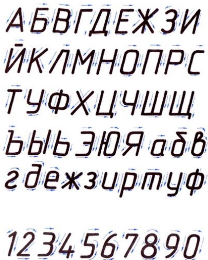
Рис. 4 Последовательность написания букв и цифр чертежного шрифта
