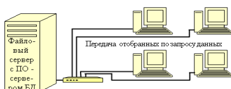
Рис. 2. Схема работы с БД в архитектуре "Клиент-сервер"
