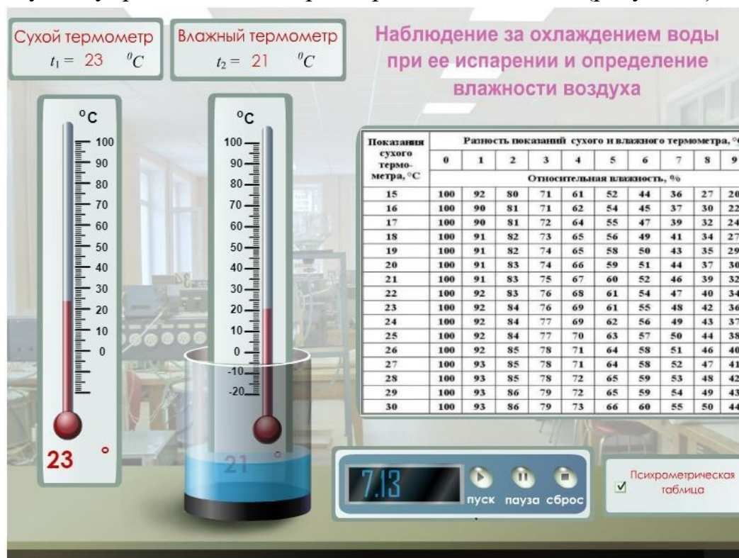
Рисунок 3 – Стенд виртуальной лабораторной работы
