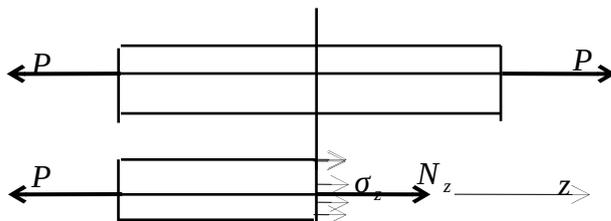
Равнодействующая внутренних нормальных сил упругости в поперечном сечении бруса называется продольной силой и обозначается  $N_z$
