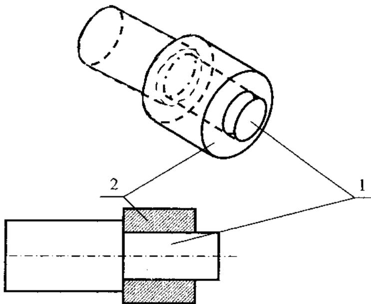
Рисунок 1 - Схема соединения отверстия и вала
