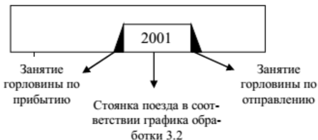
Рисунок 6.2 – Схема обработки прямого поезда в парке приема
