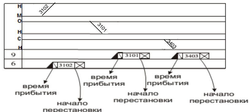
Рисунок 7.2 – Схема расчета простоя транзитных вагонов с переработкой в парке прибытия
