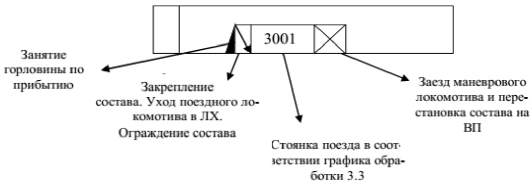
Рисунок 6.3 – Схема обработки поезда в расформирование в парке приема
