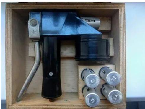
16.1. Предназначен: - для измерения напряжения на клеммах отдельных элементов аккумуляторной батареи (измерение свободности напряжения); - измерения напряжения на клеммах отдельных элементов под соответствующей данному типу аккумулятора нагрузкой.
