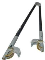
13. Шунт сопротивлением 0,06 Ом типа ШУ-01М. Предназначен для проверки шунтовой чувствительности рельсовых цепей на станциях и перегонах согласно технологической карты № 32, также стрелочные соединители параллельных ответвлений, не оборудованных путевыми реле, согласно техкарте № 32.
