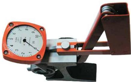
сердечники крестовин с непрерывной поверхностью касания (НПК) для их перевода, прижатия и запираения, для регулировки фрикции сцепления электроприводов в условиях эксплуатации (при монтаже вновь укладываемых и централизуемых стрелочных переводов, их техническое обслуживание и ремонт), всех видов типов (Р50 и тяжелее) марок,
