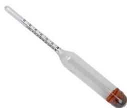
17. Ареометр типа БОМ7 или АЭ-41. Назначение: проверка состояния и плотности электролита в аккумуляторах различных типов и емкости согласно техкарте № 75 п. 2.2, 2.3.
