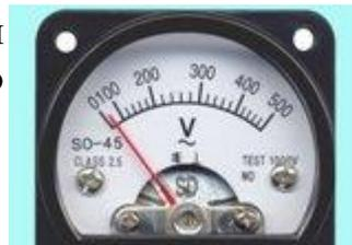
3) напряжение между проводом В и землей  $U_B$  (показание вольтметра при положении В переключателя).
