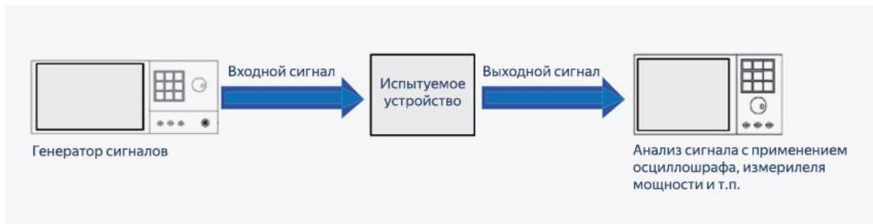
Рис. 3. Формирование генератором сигналов тестового сигнала для тестирования испытуемого устройства
