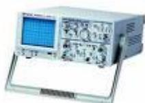
Осциллограф может быть использован как составная часть более сложной измерительной аппаратуры, например, в мостовых схемах в качестве нуль-органа, в измерителях частотных характеристик и т. д.
