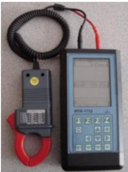
частотой 50 Гц на рабочих и свободных контактах ТР, ТШ и ДТ. Эксплуатация при температуре от  $-10^\circ\text{C}$  до  $50^\circ\text{C}$ . Питание измерителя от семи аккумуляторов типа Д-0,55 или от сети ~ напряжение 220В частотой 50 Гц через источник питания- зарядное устройство КЕУЮЗ.508.001.
