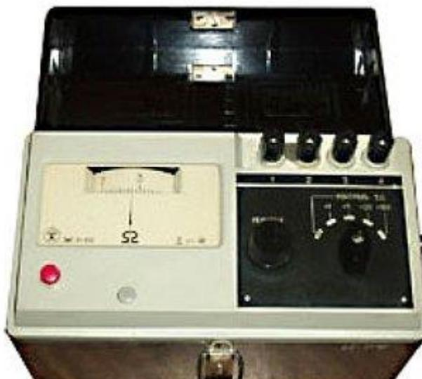
*Порядок проведения измерения сопротивления контура защитного заземления*
