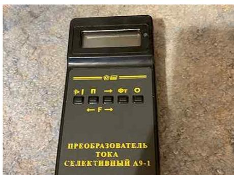
5. Преобразователь тока селективный типа А9-1. Назначение: измерение сигнального тока в кодовых р.ц. и в р.ц. тональной частоты в селективном режиме. На дистанцию этот прибор не поступал.
