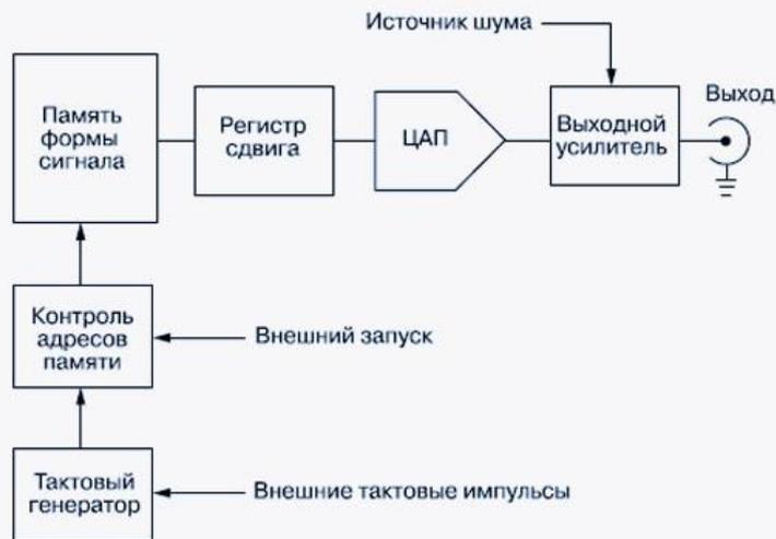
Рис. 4. Упрощенная функциональная схема генераторов класса AWG
