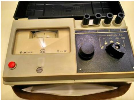
9. Измеритель сопротивления заземления типа ЭС0201 или М416. Назначение. Измерение сопротивления заземления в устройствах СЦБ, связи (постов ЭЦ, КЯ, РШ, металлических оболочек кабелей) при электротяге переменного тока.
