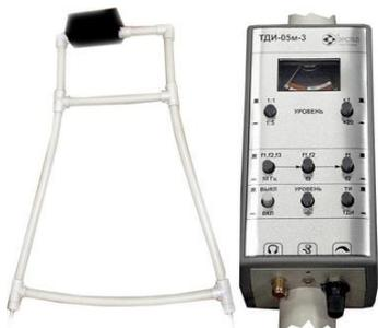
предназначен для поиска места прохождения трассы под землей, определения направления и глубины прокладки, а также для точного определения места повреждения (обрыв, короткое замыкание, утечка на землю для кабельных линий, нарушение защитной оболочки для трубных линий).
