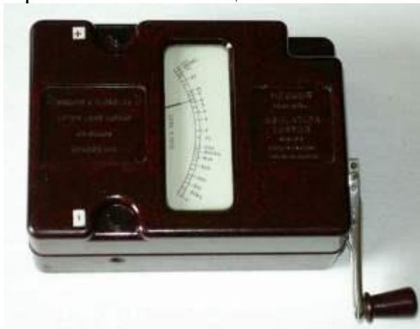
Измерение сопротивления изоляции кабеля осуществляют между фазными проводниками, фазными проводниками и нейтральными, фазными проводниками и землей, нейтральными проводниками и землей. Если проверка проводится в соответствии с нормами ПТЭЭП, то кабель обязательно демонтируется.
