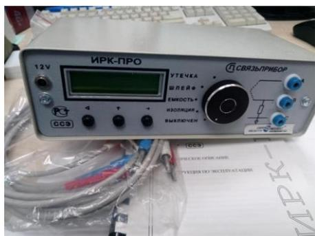
19.1. Назначение. Прибор предназначен для определения расстояния до участка с пониженным сопротивлением изоляции всех типов симметричных кабелей, измерения сопротивления изоляции и сопротивления шлейфа, омической асимметрии, измерения электрической емкости кабеля.
