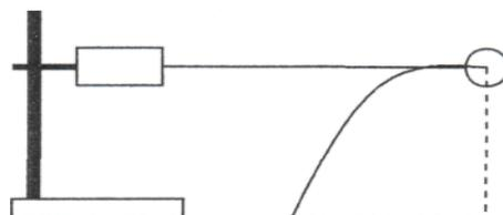
быть равно изменению кинетической энергии тела связанного с пружиной, взятому с обратным знаком. Для проверки этого утверждения можно воспользоваться установкой изображённой на рисунке. Закрепив динамометр в лапке штатива, прикрепляют нить с шариком к пружине и натягивают ее, держа нить горизонтально. Когда шар отпускают, он под действием силы упругости приобретает скорость  $V$ . При этом потенциальная энергия
