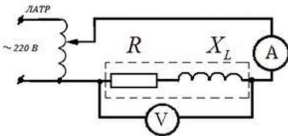
3. С помощью регулятора напряжения подать на схему напряжение 1,5 В и установить частоту переменного тока 80 Гц. Записать показания миллиамперметра.
