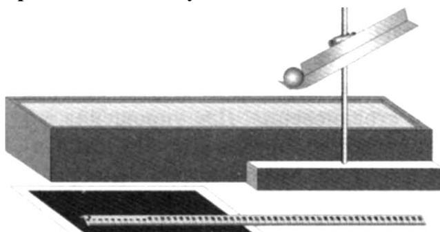
Столкновение шаров происходит после того, как один из них помещают на край горизонтального участка желоба, а второй пускают по желобу с некоторой высоты. После столкновения шары, описав параболические траектории, падают на поверхность стола.
