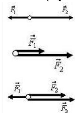
4. Трактор тянет плуг по горизонтали силой 5 кН. Сопротивление движению 3 кН. Определите равнодействующую этих сил.
