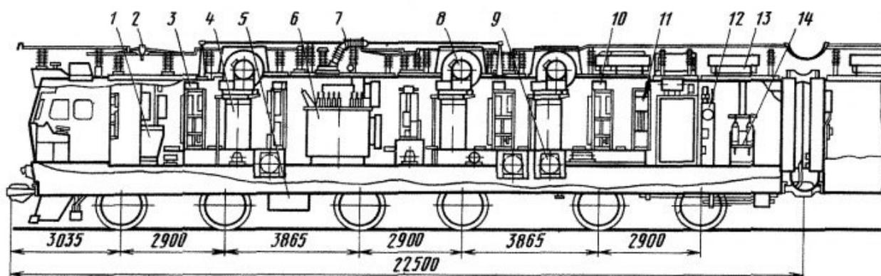
Рис 12 Расположение оборудования на секции электровоза ВЛ85
