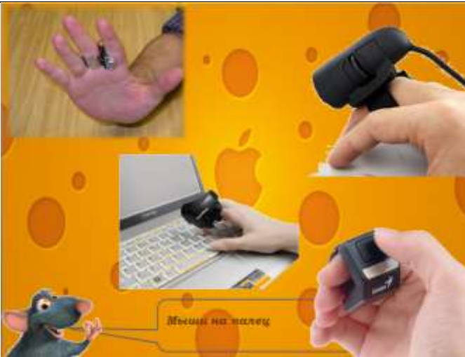
А эта мышь, по-моему, инновационная. Новое устройство управляет компьютером крутится к ладони и двумя пальцами: среднему и указательному. На внутренней стороне ладони располагается, привычный уже в компьютерных мышках, лазер, отслеживающий перемещение.
