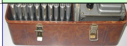
Рис. 4 Комплект индивидуальных дозиметров ДП-22В
