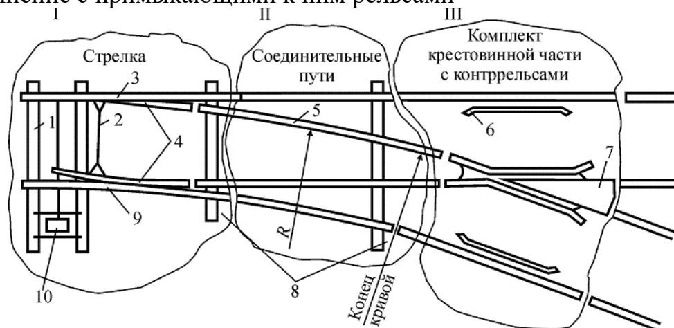
Рисунок 1 Обыкновенный одиночный стрелочный перевод
