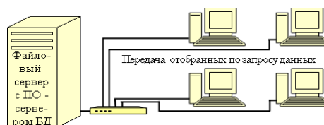
Рис. 2. Схема работы с БД в архитектуре "Клиент-сервер"
