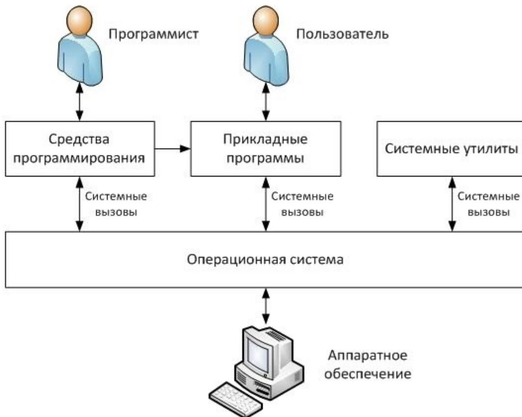
**Рис. 1.1.** Компоненты вычислительной системы
