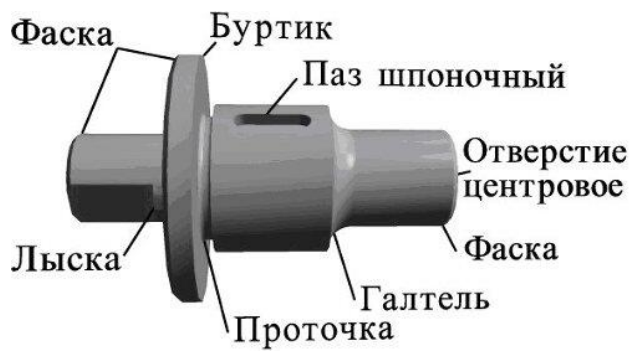
Рисунок 2 Деталь с конструктивными элементами\
