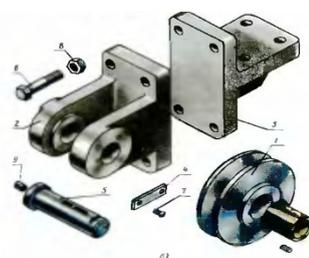
Рисунок 2 Составные части «Блока направляющего»
