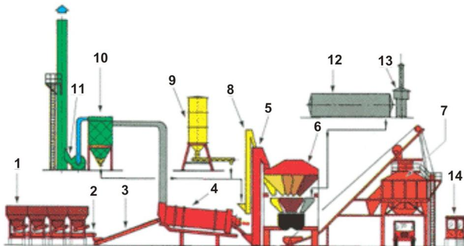
Задание: опишите технологический процесс приготовления асфальтобетонной смеси в установке циклического действия согласно приведенной схеме
