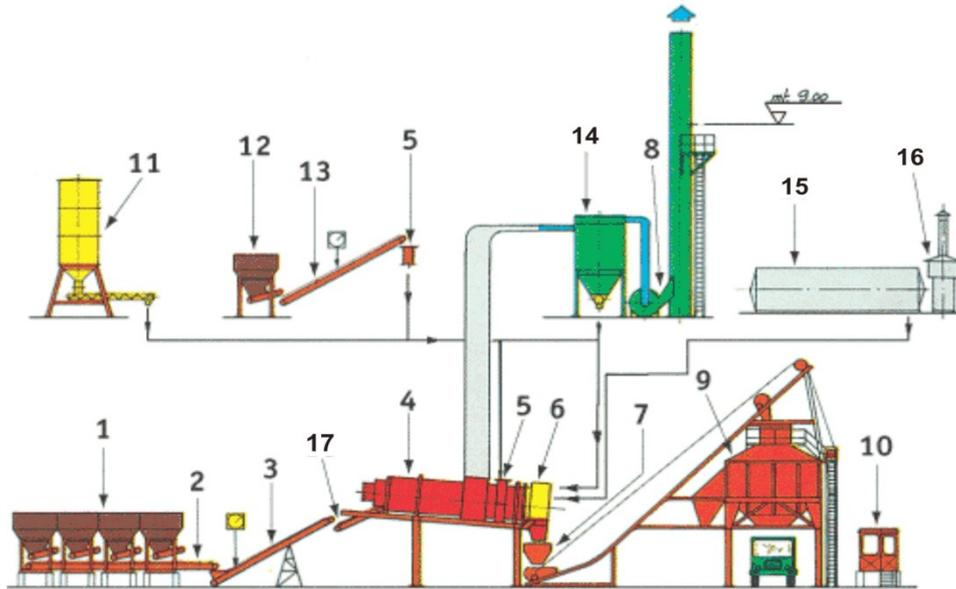
Задание: опишите технологический процесс приготовления асфальтобетонной смеси в установке непрерывного действия, согласно приведенной схеме
