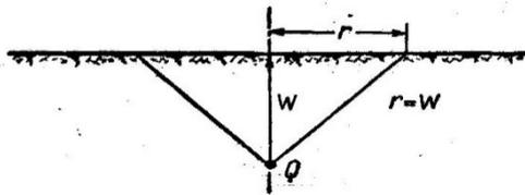
Рисунок 1—Воронка, которая образуется в результате взрыва нормального выброса
