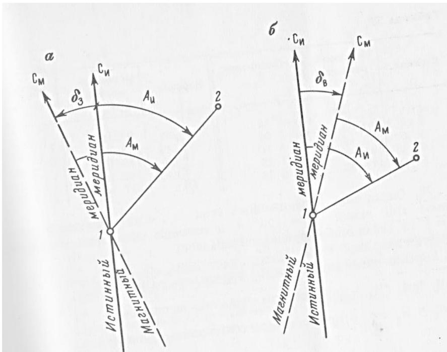
Рис. 1. Склонение магнитной стрелки: а – западное; б - восточное
