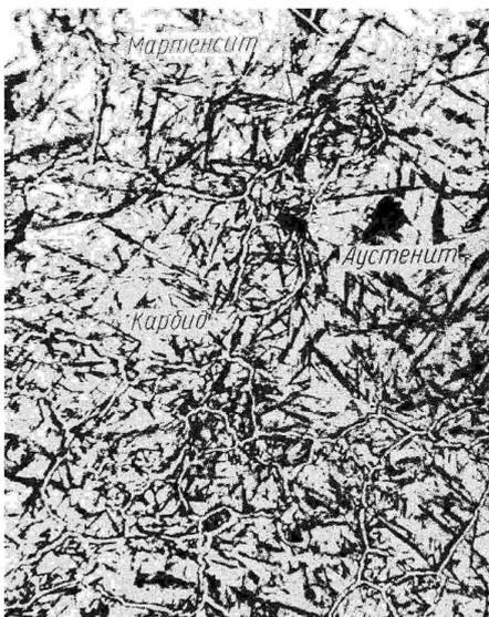
Закалку изделий из углеродистых сталей производят в целях повышения характеристик прочности, твердости и износостойкости. Наиболее распространенным режимом закалки является выдержка (для выравнивания температуры по сечению изделия) и охлаждение со скоростью, равной или больше критической (для углеродистых сталей обычно в воде).
