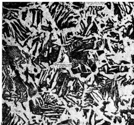
Стали, получившие видманштеттову структуру или структуру перегрева, характеризуется пониженными свойствами по пластичности и ударной вязкости. Для исправления такого рода структур изделия подвергают повторному отжигу или нормализации.
