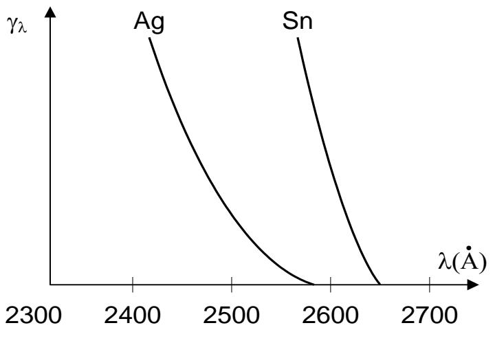
Рис.1.4. Спектральная чувствительность  $\gamma_\lambda$  фотокатода
