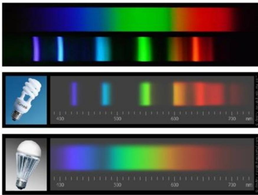
**Непрерывный спектр излучения 60-ватной [лампы накаливания](#) (вверху) и полосатый спектр излучения 11-ватной компактной люминесцентной лампы (внизу)**
