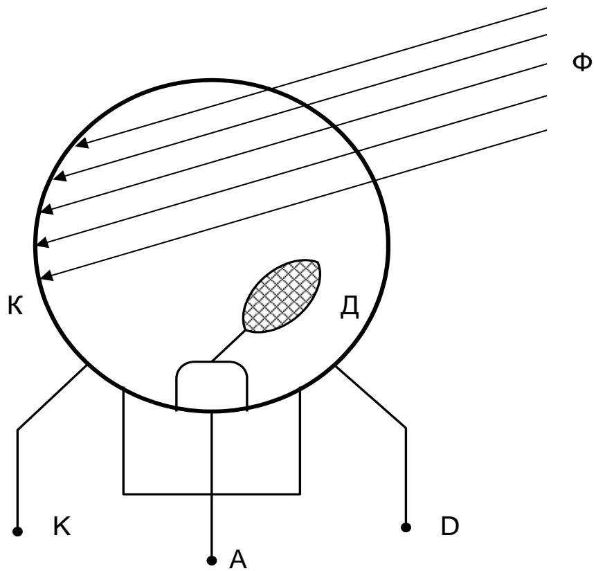
Рис. 1.6. Схема фотоэлемента с усилением фототока:
