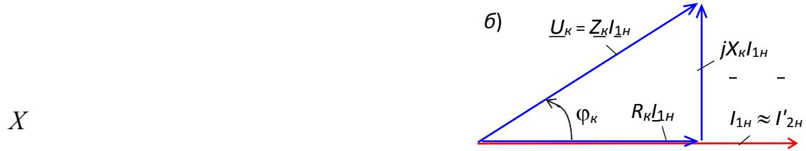
Рис.6. Схема первичной обмотки трансформатора и векторная диаграмма напряжений на ней в режиме КЗ.
