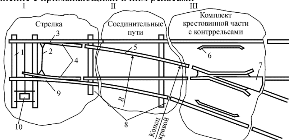
Рисунок 1 Обыкновенный одиночный стрелочный перевод
