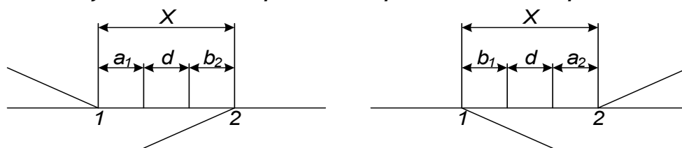
Рисунок 5 Схемы взаимного расположения стрелочных переводов при попутной укладке.
