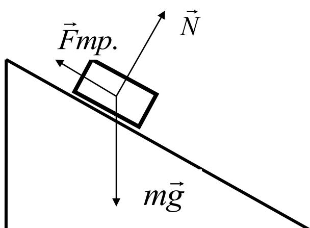
На тело действуют 3 силы. Если геометрическая сумма сил больше нуля, тело движется с ускорением.
