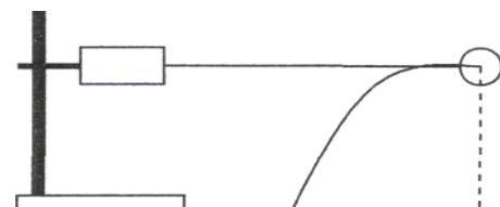
быть равно изменению кинетической энергии тела связанного с пружиной, взятому с обратным знаком. Для проверки этого утверждения можно воспользоваться установкой изображённой на рисунке. Закрепив динамометр в лапке штатива, прикрепляют нить с шариком к пружине и натягивают ее, держа нить горизонтально. Когда шар отпускают, он под действием силы упругости приобретает скорость  $V$ . При этом потенциальная энергия
