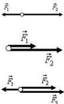
4. Трактор тянет плуг по горизонтали силой 5 кН. Сопротивление движению 3 кН. Определите равнодействующую этих сил.
