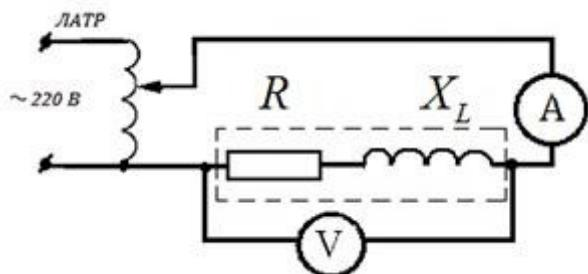
изменяя напряжения и частоты переменного тока, записать показания миллиамперметра в таблицу.
